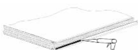
Slika 9. Prikaz brtvljenja silikonskim kitom
