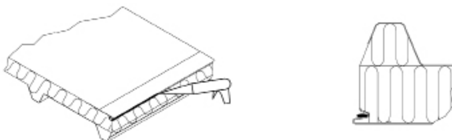
Slika 7. Prikaz brtvljenja silikonskim kitom i položaja gdje je potrebno nanijeti kit
